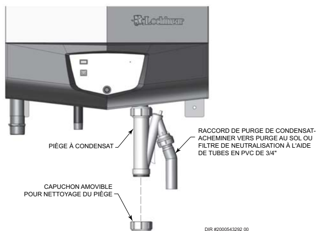
Figure 2-2 Rejet du condensat
